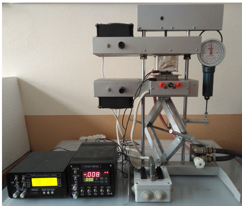
Рис. 6. Зовнішній вигляд обладнання для вимірювання параметрів термоелектричних модулів охолодження
