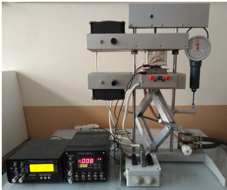
Рис. 1. Зовнішній вигляд обладнання для вимірювання параметрів термоелектричних модулів
