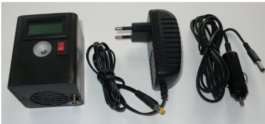
Рис. 7. Зовнішній вигляд тестера для вимірювання температури замерзання антифризу.
