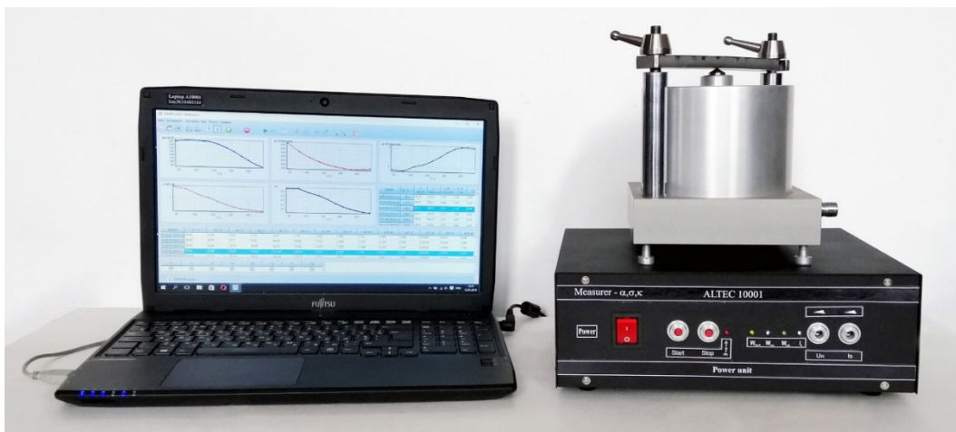
Рис. 1. Установка «АЛТЕК-10001» для вимірювань термоелектричних властивостей матеріалів комплексним абсолютним методом, розроблена в Інституті термоелектрики НАН та МОН України.
