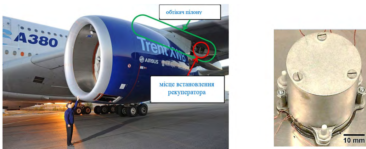
Рис. 12. Місце встановлення і зовнішній вигляд термоелектричного рекуператора, що використовує теплові відходи турбіни літака Airbus A 380 [116].
