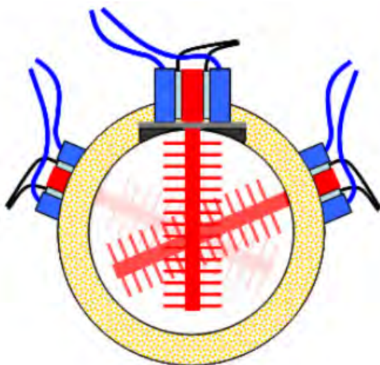
Рис. 7. Монтаж термоелектричного генератора в повітропроводі бойлера [38].
