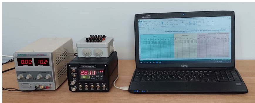
Рис. 4. Зовнішній вигляд системи автоматизації вимірювань параметрів термоелектричних модулів.
