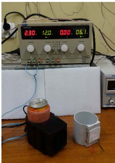
Рис. 1. Автомобільний охолоджувач напоїв Car mini-cooler FM 201.001 (зліва), справа окремо його ємність з встановленим на ній термоелектричним модулем
