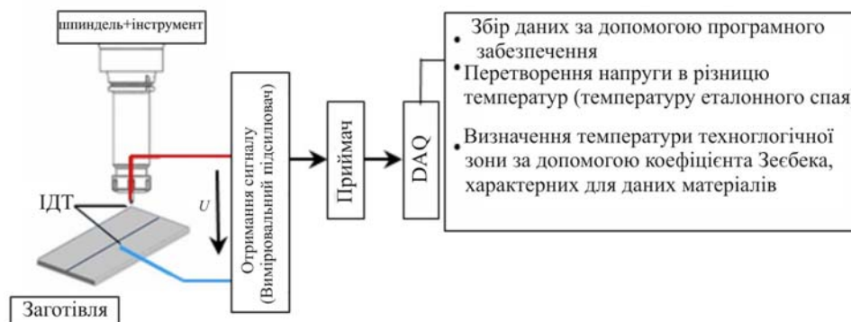
Рис. 3. Основний принцип методу інструмент-деталь-термопара (ІДТ) [11]
