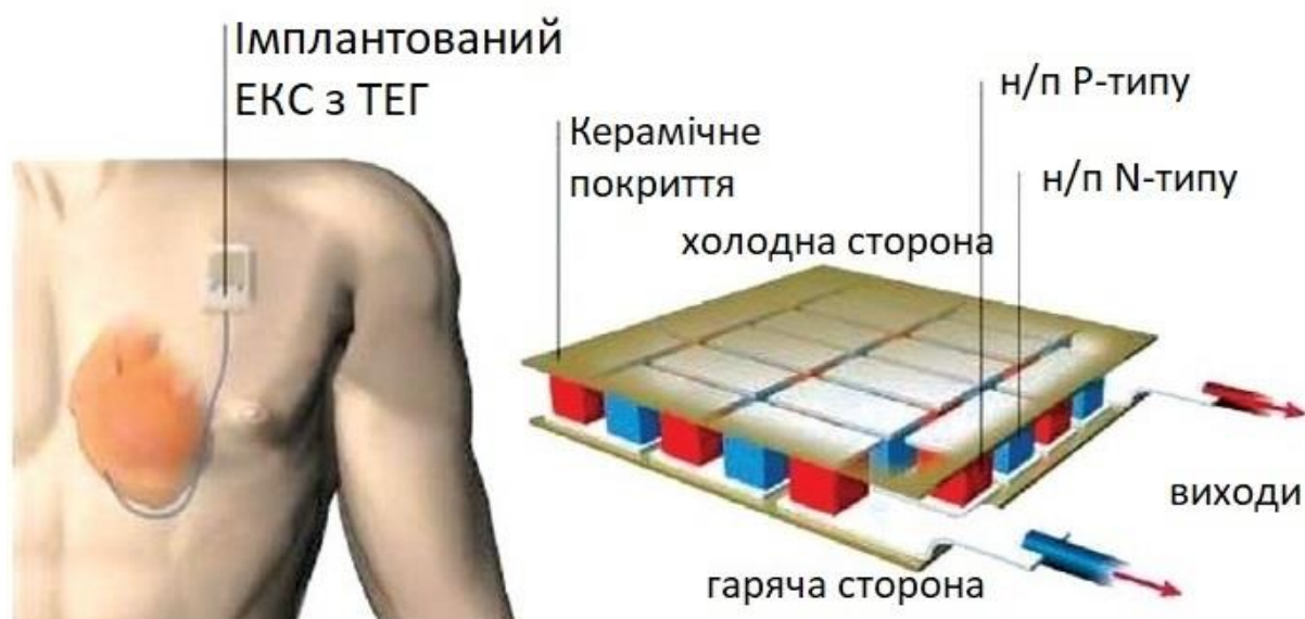
Рис. 15. Схематичне зображення імплантованого ЕКС з ТЕГ [49, 55]
