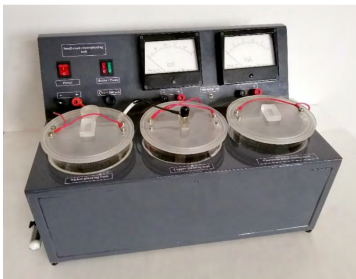
Рис. 10. Зовнішній вигляд установки для створення контактних структур на вимірюваних зразках термоелектричних матеріалів.
