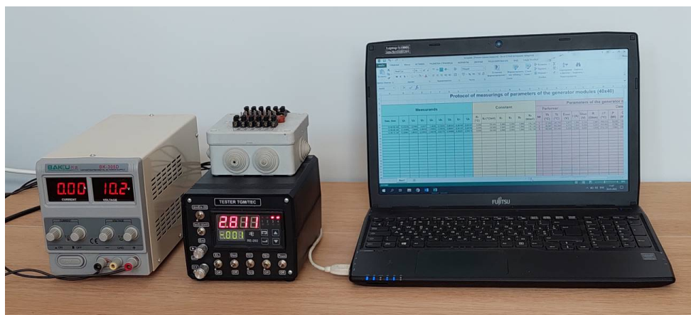
Рис. 2 – Зовнішній вигляд системи автоматизації вимірювань параметрів термоелектричних генераторних модулів
