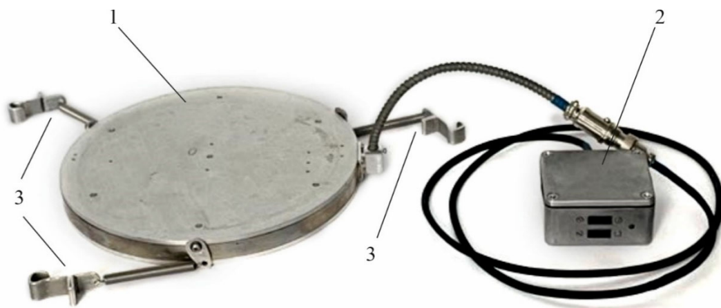
Рис. 2. Зовнішній вигляд універсального термоелектричного генератора: 1 – термоелектричний генератор; 2 – електронний блок стабілізації вихідної напруги; 3 – гачки на пружинах для кріплення генератора на ємності з водою
