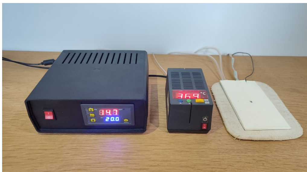
Рис. 2. Зовнішній вигляд експериментального зразку приладу для іонофорезу
